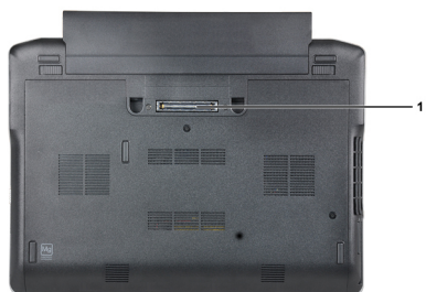
1. Port na pripojenie dokovacej stanice
